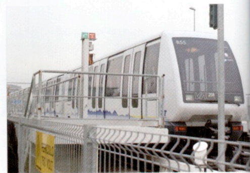
Vías de entrada a los talleres del metro de Turín, situados al fondo. En la vía se puede ver el sistema de rodadura por guía central y lateral
